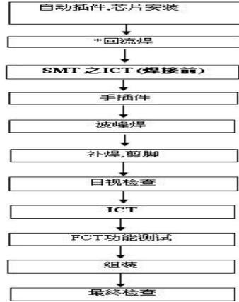
ICT 治具是针对印刷电路板制作过程中容易出现问题的工序（贴片，插件、回流焊、波峰焊）进行检查。提前发现问题避免后工序使用不良品作业。
